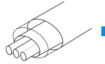
アース用に付加遮蔽材(メッシュ or 導電布)を利用する方法です。 =必要な長さだけ付加遮蔽材を残し余分なシート部を切り落とします。
