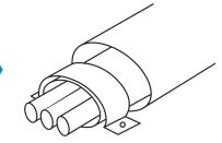
露出した付加遮蔽材(メッシュ or 導電 布)にアースクランプを付けてグランド に落とします。
