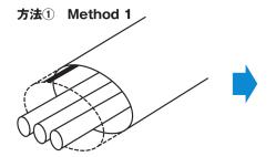
アース用編組線を必要な長さだけ残し 余分なシート部を切り落とします。 Cut extra length of sheet material to get the desired length of the braided grounding wire.
