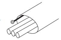
アース用編組線に端子を付けて グランドに落とします。 Put a terminal on the grounding wire and connect to ground.
